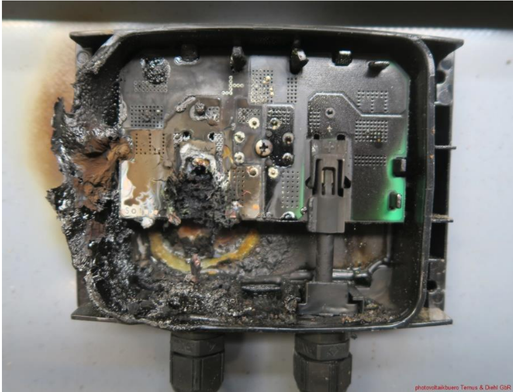
Imagem 3. Caixa de junção parcialmente carbonizada.
