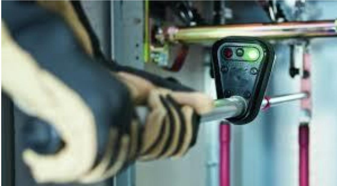
**Imagem 2. Detalhes do detector de tensão DEHN+SÖHNE**
